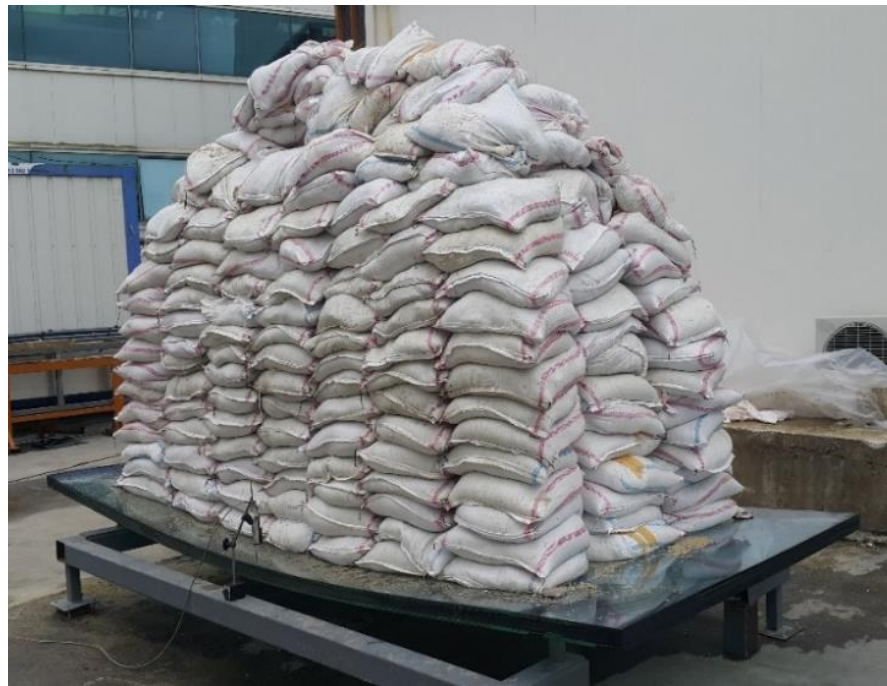
تست بارگذاری شیشه جهت "بررسی عملی" میزان تغییر شکل گسیختگی - پروژه ایران مال
