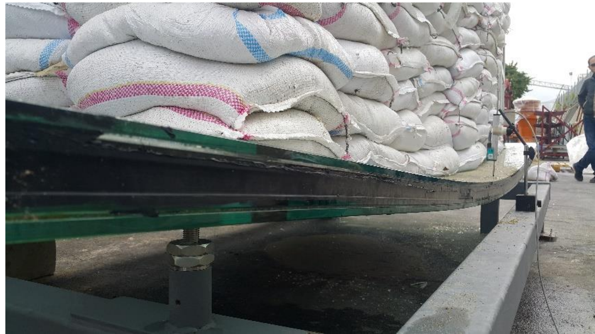
تست بارگذاری شیشه جهت "بررسی عملی" میزان تغییر شکل گسیختگی - پروژه ایران مال
